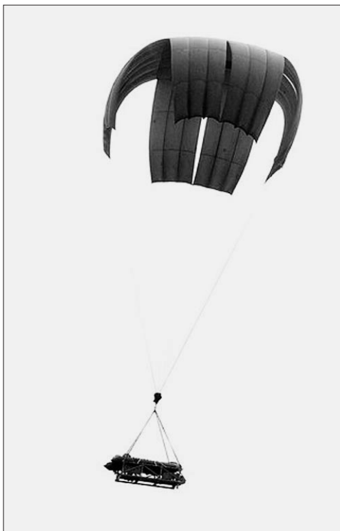
Сброс с самолета С-130 надувных резиновых моторных лодок в район аварии ПЛ для действий парашютно-десантной спасательной группы
