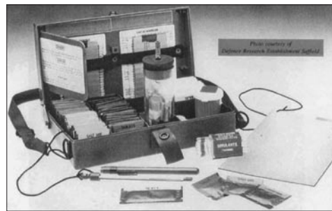
Рис. 2. Индикаторный комплект для анализа воды M272
